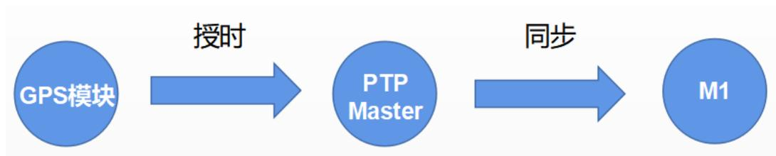
图 6: GPS 同步拓扑简图
